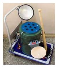
При градуировке, калибровке или поверке TC рекомендуется проводить измерения в реперной точке в нулевом термостате при  $0\,^{\circ}$ С или в высокостабильном жидкостном термостате (нестабильность не более  $\pm\,0,002\,^{\circ}$ С). Для создания реперной точки  $0\,^{\circ}$ С рекомендуем использовать термостаты нулевые "Лёд-Сибирь", производства ООО "КТС-сервис".
